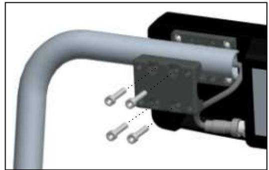
Рисунок 4 – Установка терминалов на круглой вращающейся стойке
