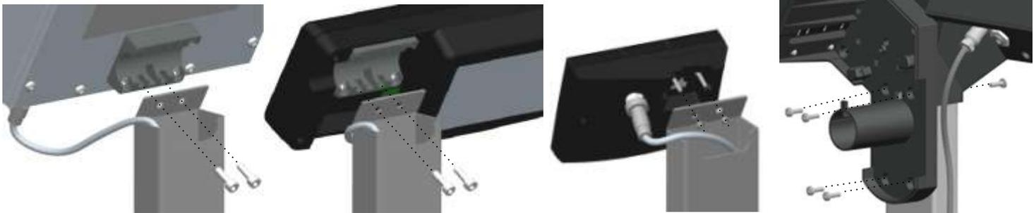
Рисунок 5 – Установка терминалов на прямоугольной стойке
